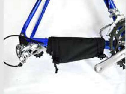
Der Schutz wird mit dem gepolsterten Bereich einmal um die Kettenstrebe gewickelt und mit den ersten Klettstreifen befestigt. Das Schaltauge wird nach vorne gespannt und mit dem seitlichen kleinen Gurt festgeklettet. Anschließend wird die Kette soweit wie möglich gesammelt und zu dem Schaltauge in den Schutz gelegt. Dieser wird nun umgeschlagen und befestigt. Zum Schluss ziehen Sie die Kordeln stramm und sichern damit die Kette und das Schaltauge.
