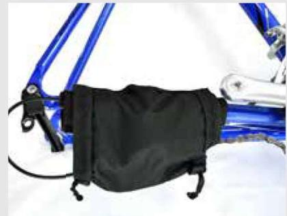
Der Schutz wird mit dem gepolsterten Bereich einmal um die Kettenstrebe gewickelt und mit den ersten Klettstreifen befestigt. Das Schaltwerk wird abgeschraubt und zusammen mit der Kette in den Schutz gelegt. Anschließend wird der Schutz umgeschlagen und mit dem Klett befestigt. Zum Schluss ziehen Sie die Kordeln stramm und sichern damit das Schaltwerk und die Kette.
